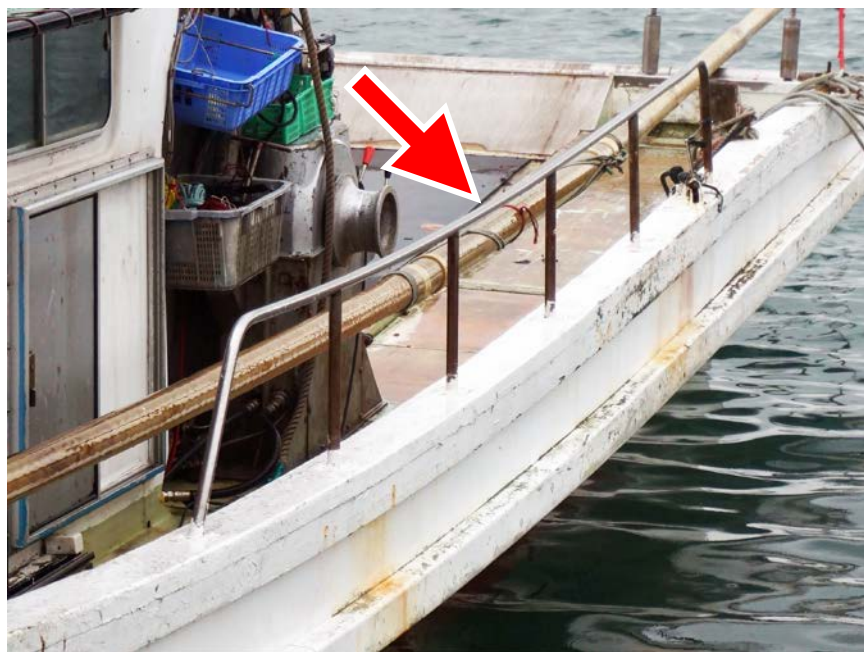
手すりの設置例①
