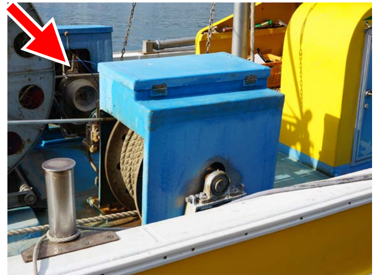
ワープ（曳網）ウィンチに設置した カバーの例
