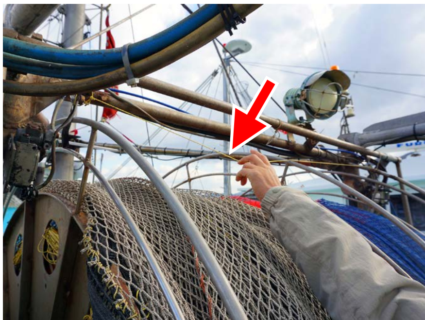
非常停止装置の設置例①
