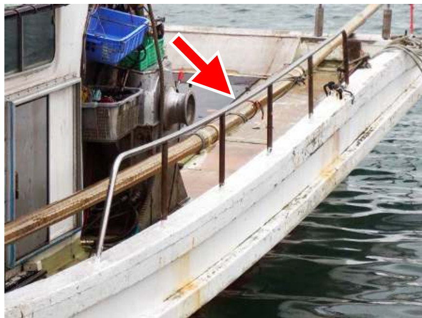
手すりの設置例①
