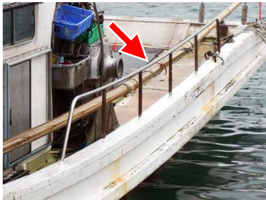
手すりの設置例①
