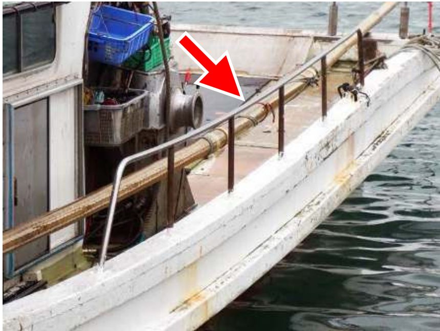
手すりの設置例①
