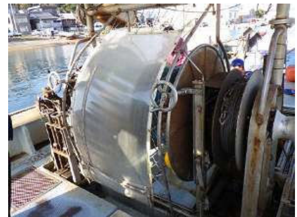
ネットウィンチに設置したカバーの例
